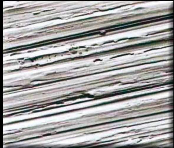
Oberfläche geschliffen, Korn 320, 650fach vergrößert.
